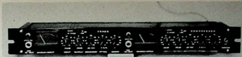
Afb. 14 De compressor-limiter in stereo-uitvoering in een 19"-kast. In het midden en geheel links is het gecombineerde in- en uitgangschassisdeel te zien en de overbruggingsschakelaar.
